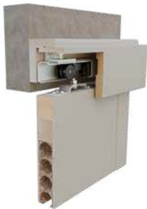
NS sistema – montuojama tiesiogiai ant sienos
