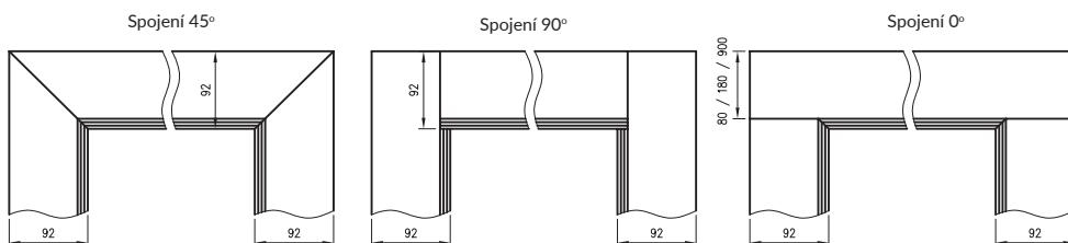
Poznámka: Rám 075-095 má jiný průřez, pro tloušťku stěny 75-89 mm bude nutné zkrátit pero pohyblivého úhlu.
