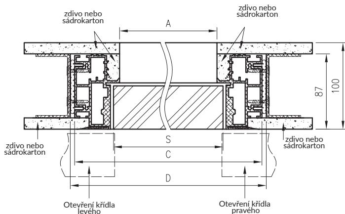
Svislý průřez dveří 50mm bezfalcové
