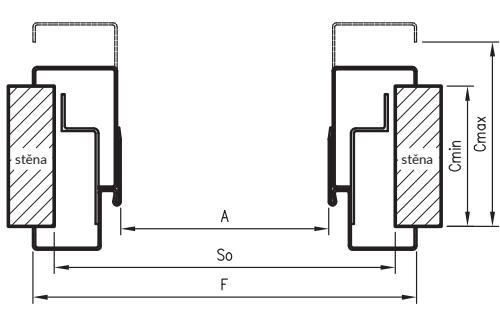
S0 - šířka montážního otvoru
