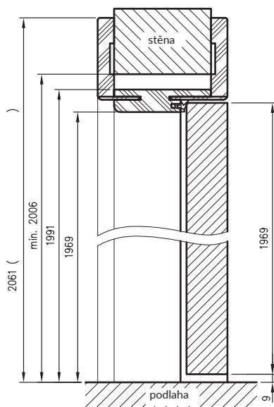
požadovaná výška stavebního otvora 2006mm
