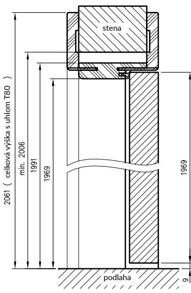
požadovaná výška otvoru v múre 2006 mm
