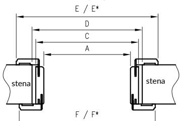
D - požadovaná šírka otvoru v stene
