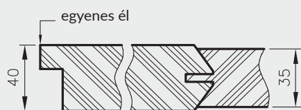
Viszszintes Elsa ajtópanel keresztmetszet
