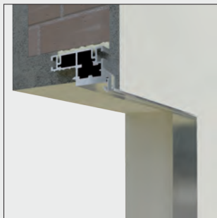
Fordított falcolású ajtótokok profil falc
