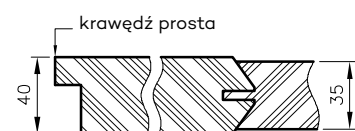
Przekrój poziomy drzwi Elsa
