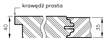
Przekrój poziomy drzwi Nestor
