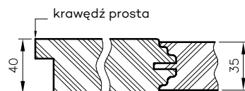
Przekrój poziomy drzwi Nestor
