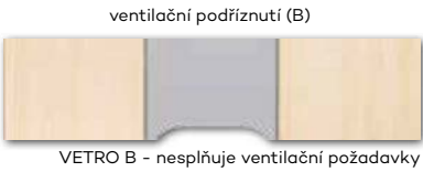
VETRO B - nesplňuje ventilační požadavky
